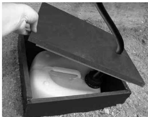
Рис. 1. Канистра для сбора фильтрата
