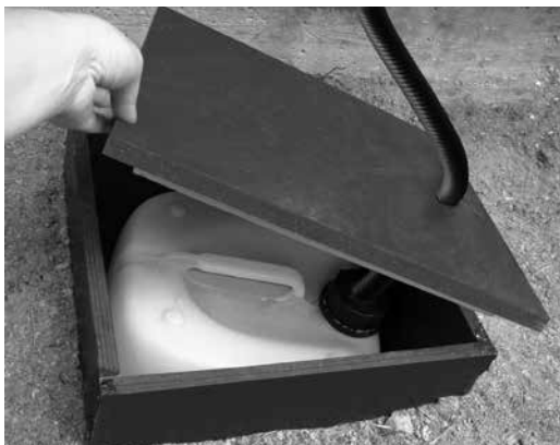
1 paveikslėlis. Besisunkiančio skysčio surinkimo talpykla
