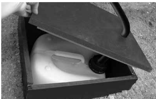
Abbildung 1. Sammelbehälter für Sickerflüssigkeit
