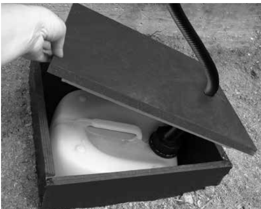
Bild 1. Uppsamlingsbehållare för sippervatten
