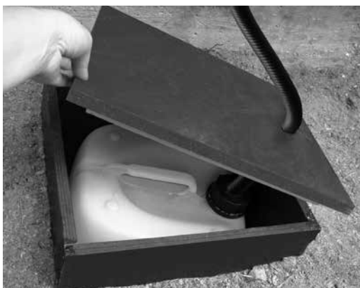
1. attēls. Filtrāta šķidruma savākšanas konteiners
