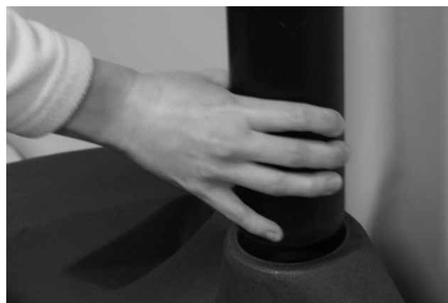
3. Отсоединение вентиляционной трубы.
