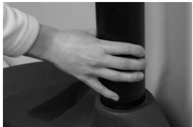
3. Démontage du tuyau de ventilation.
